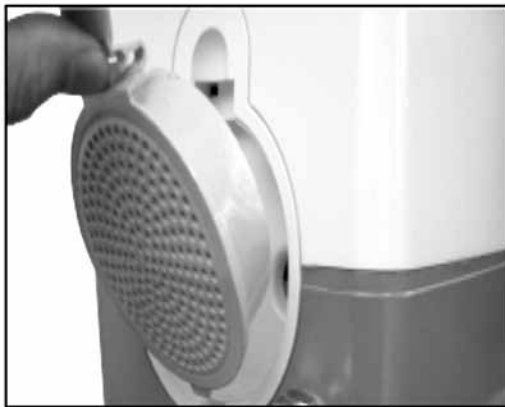
ภาพที่ 23 แสดงตัวกรองฝุ่นและแบคทีเรียของเครื่องช่วยหายใจที่ใช้ที่บ้าน
