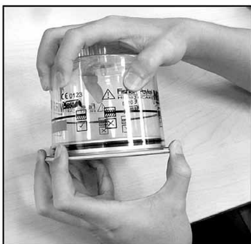
ภาพที่ 19 แสดงการแยกชิ้นส่วนหม้อไอน้ำเครื่องทำความชื้น
