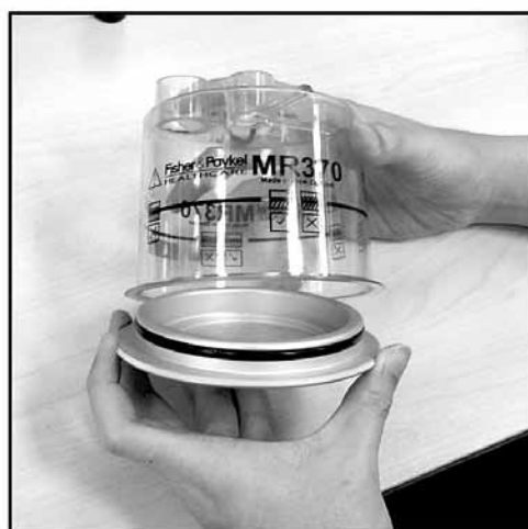
ภาพที่ 19 แสดงการแยกชิ้นส่วนหม้อไอน้ำเครื่องทำความชื้น
