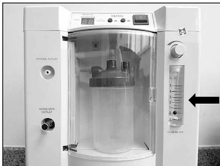
ภาพที่ 4 แสดง low pressure gas regulator หรือ flow meter (ลูกศรชี้) บนเครื่องผลิตออกซิเจน
