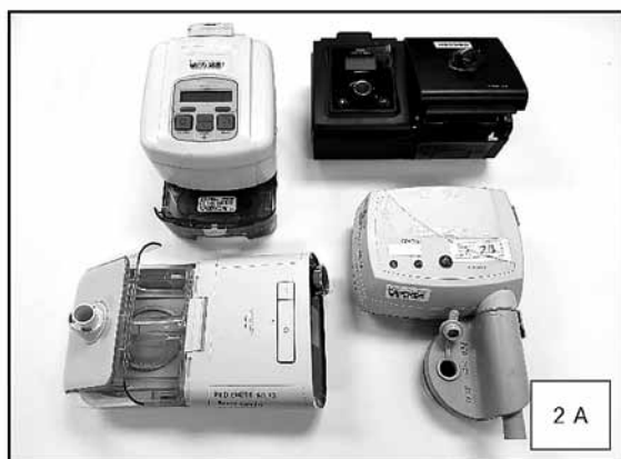
ภาพที่ 2 แสดง passover heated humidifier แบบติดตั้งเป็นส่วนประกอบอยู่ในเครื่องช่วยหายใจ (2 A) และแบบเครื่องทำความร้อนที่ต่อเพิ่มเข้าไปในระบบ (2 B)
