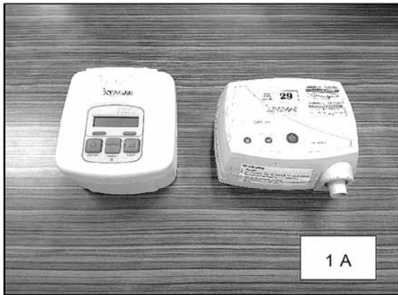
ภาพที่ 1 แสดง pressure - targeted ventilator ชนิด continuous positive airway pressure (1 A) และ bilevel positive airway pressure (1 B)
